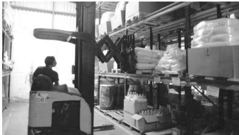
Fotografía 2. Montacargas de doble alcance.
