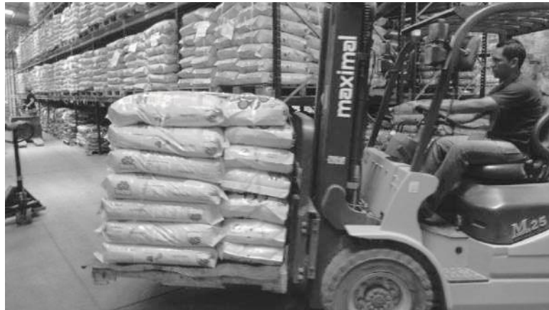
Fotografía 1. Montacargas de contrapeso.
